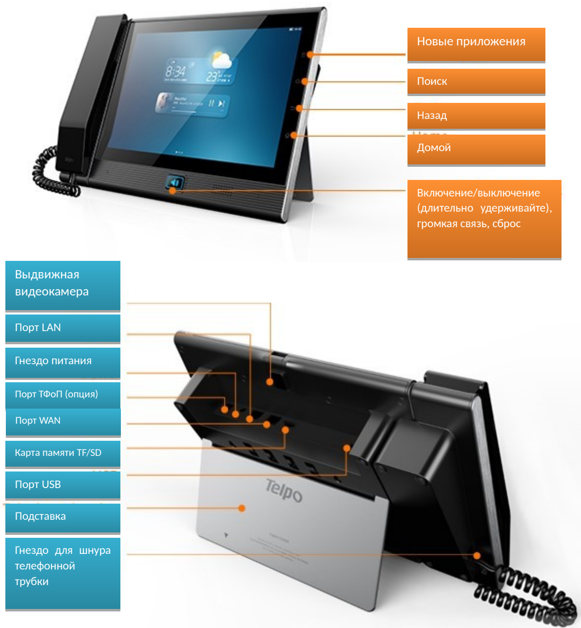
Рис. 3 Физические клавиши и физические интерфейсы IP-видеотелефона V200
