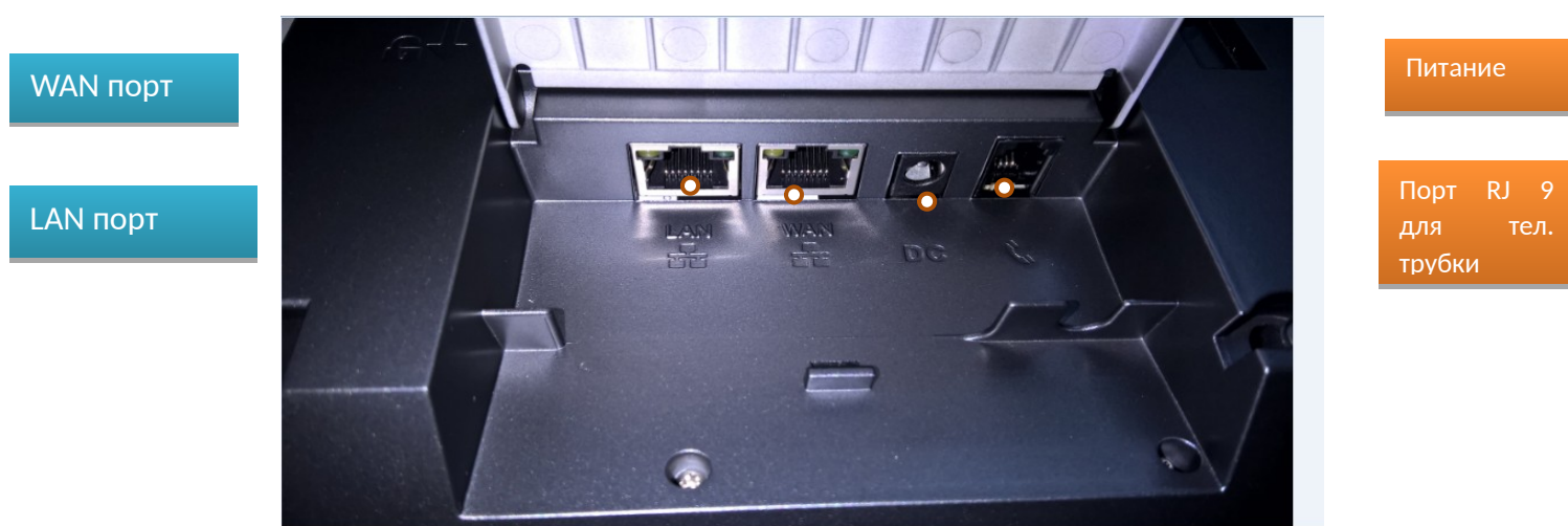
Рис. 2 Описание физических интерфейсов IP-видеотелефона V100
